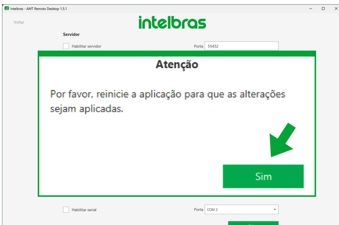
O software será fechado, basta abrir novamente e os dados que faziam parte do Backup do **AMT Remoto V6** foram transferidos para o **AMT Remoto Desktop**.
