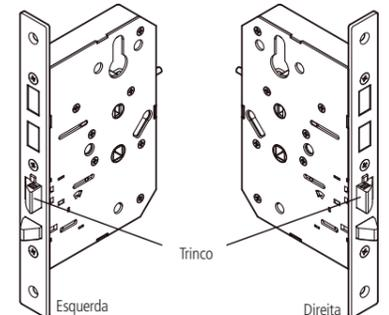
2. Caso seja necessário inverter a posição do trinco, remova os parafusos e a falsatesta e gire o trinco de acordo com seu cenário. Por fim, insira novamente a falsatesta e os parafusos.
