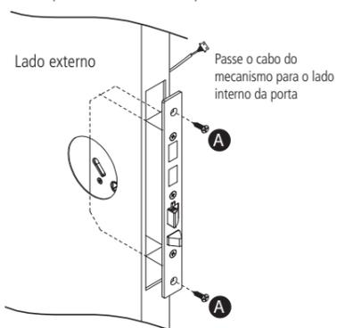
**Importante:** ao encaixar o mecanismo na porta, certifique-se que o cabo não sofrerá nenhum tipo de dano. Não faça a instalação caso notar qualquer dano no cabo do mecanismo! Nesta situação, procure uma assistência técnica autorizada.
