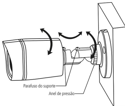
3. Após ajustar a posição da câmera, aperte os parafusos para que o ângulo da imagem se mantenha fixo.
