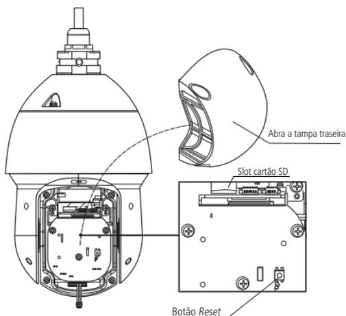
2. Feche a cúpula da câmera, certificando-se de que os 4 parafusos estejam apertados e que a cúpula esteja bem encaixada.
