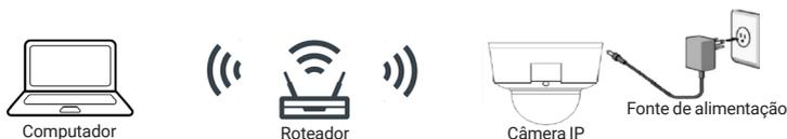
2. Após a câmera estar ligada, irá aparecer uma nova rede Wi-Fi para conectar sob o SSID *VIPW-Número-de-série*;
