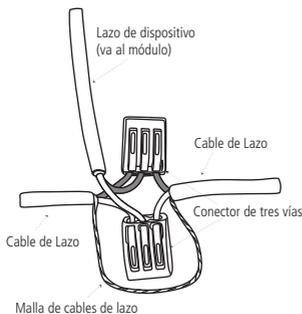
Para facilitar la instalación del módulo, realice la conexión del lado en la caja de conexiones, utilizando conectores de tres vías.
