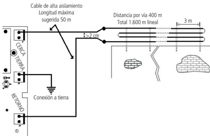
Mantener una distancia mínima de 15 cm entre los cables y del cable hasta el muro.
