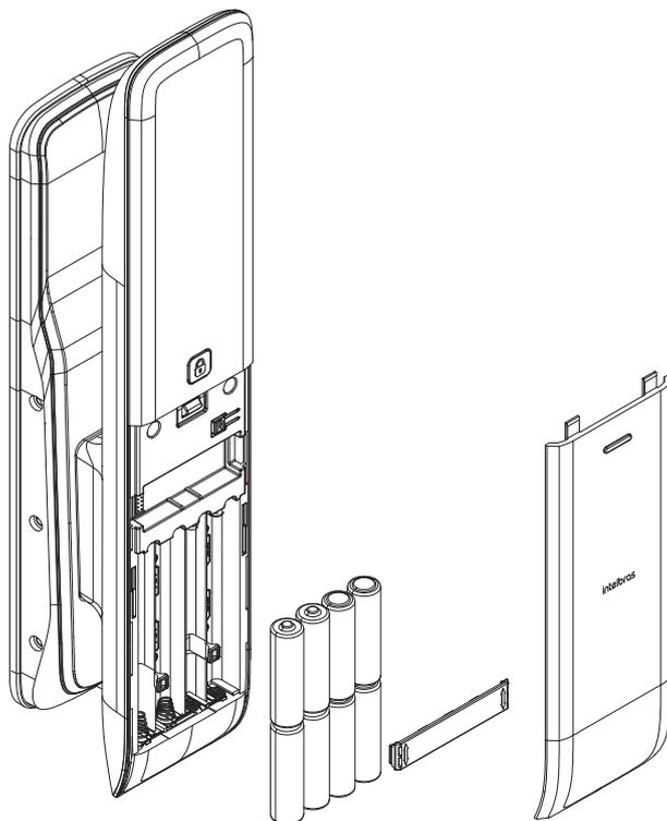
2. **Retire o módulo ZigBee:** abra o compartimento do botão de cadastro, aonde encontra-se o módulo ZigBee, e retire a placa com cuidado para não danificar o conector.
