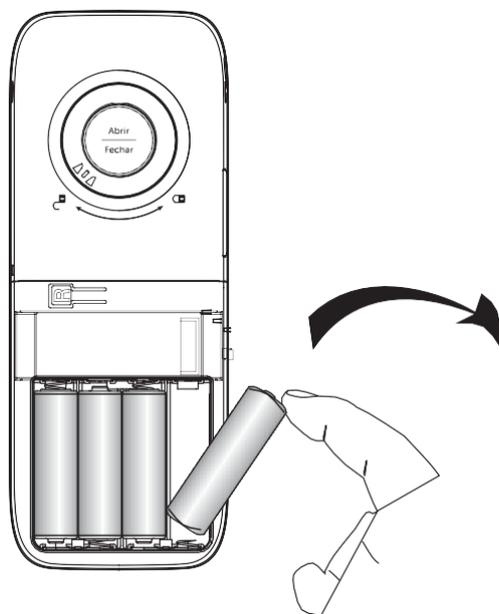
2. Retire o módulo ZigBee: abra o compartimento de pilhas, aonde encontra-se o módulo ZigBee, e retire-o com cuidado para não danificar o conector.
