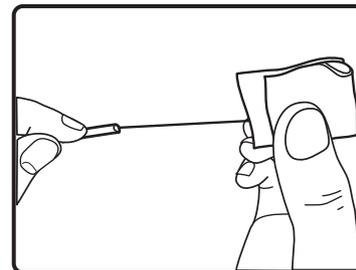
5. Limpiar la fibra óptica con un pañuelo humedecido con alcohol isopropílico
