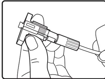
4. Conecte la fibra óptica al conector moviendo la llave hasta el final del conector de campo.
