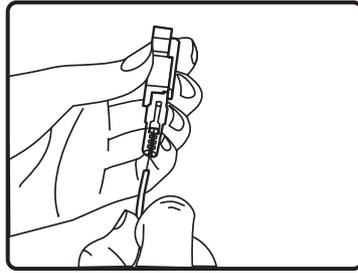
2. Inserte la fibra en el conector hasta que sienta una ligera curvatura en la fibra
