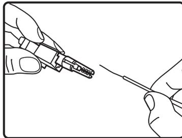
4. Retire la fibra óptica del conector
