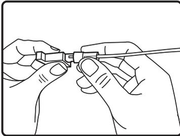
3. Bloquear el cable en el conector con la rosca de fijación
