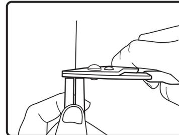
3. Inserte el cable en la plantilla de montaje, hasta la marca indicada
