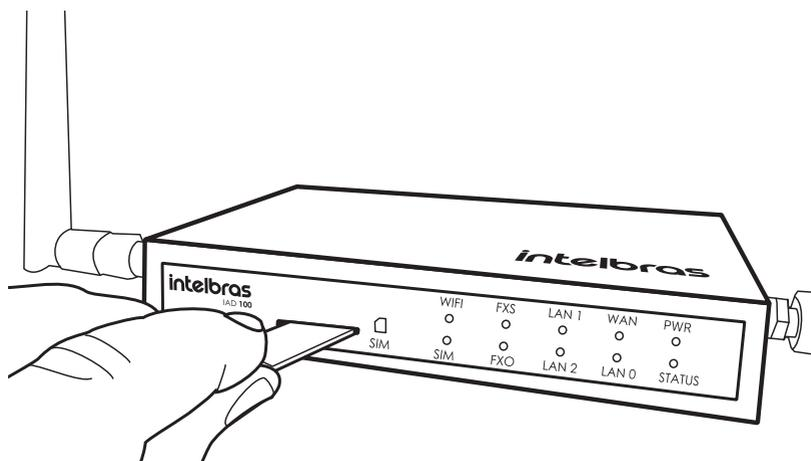
**Atenção:** para a inserção correta, atente-se para a ilustração de posicionamento tampografada na tampa frontal do gabinete. O cartão SIM só será considerado inserido quando estiver completamente travado no slot.
