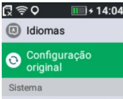
Ao pressionar *OK* sob a opção *Configuração original* deverá aparecer uma mensagem informando que a ação apagará todos os dados. Pressione *OK* novamente para iniciar o processo de restauração.
