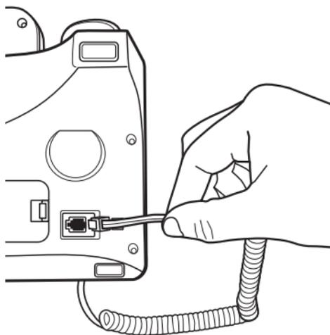
Instalação do cabo espiral
