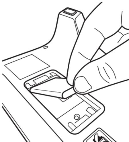
4. Coloque novamente a tampa do compartimento da bateria;
