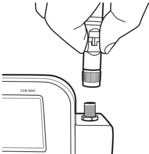
Instalação da antena
