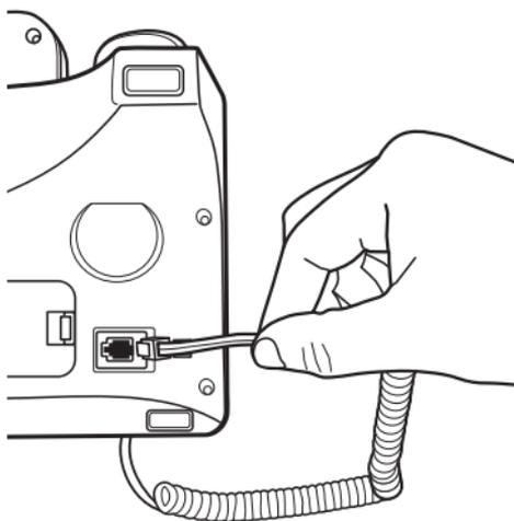
*Instalação do cabo espiral*
