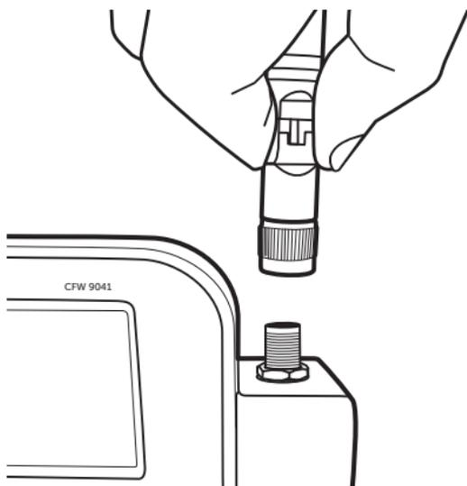
*Instalação da antena*
