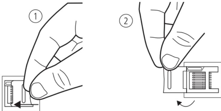
4. Após inserir o cartão micro-SD (3), baixe a grade (4) novamente e trave-a empurrando a grade para trás (5), conforme figura abaixo<sup>1</sup>.
