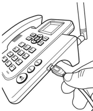
1. Conecte o adaptador AC/DC à tomada elétrica. O aparelho deve ficar constantemente conectado à rede elétrica para seu perfeito funcionamento.
