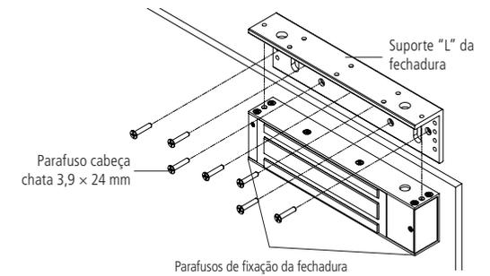
**Obs.:** os parafusos de fixação estão embutidos na eletrôimã. Para realizar a instalação da eletrôimã no suporte utilize a Chave Allen 5 mm (Item 7) do item 3. Conteúdo da embalagem desse guia.
