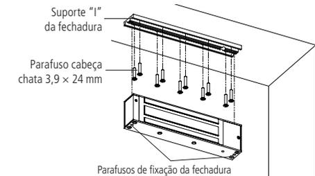
**Obs.:** os parafusos de fixação estão embutidos na eletrôimã. Para realizar a instalação da eletrôimã no suporte utilize a Chave Allen 5 mm (Item 7) do item 3. Conteúdo da embalagem desse guia.
