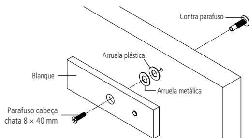
Se necessário, ajuste a distância entre o suporte do blanque e a fechadura (máx. 14 mm).
