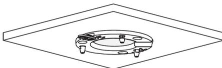
2. Encaixe a câmera no suporte de fixação, certificando-se de que a trava está correta, conforme a imagem abaixo.
