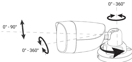
2. Após a instalação, aperte o anel da base para fixar a câmera na posição desejada.
