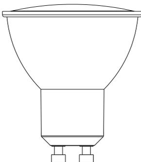
Certifique-se de que a energia esteja desligada antes de começar a instalação e que o local possua sinal Wi-Fi 2,4 GHz. A lâmpada deve ser instalada em um bocal GU10 e, uma vez configurada, pode ser utilizada como uma lâmpada comum, o que permite o acionamento pelo interruptor. No entanto, as funcionalidades inteligentes estão restritas ao uso do aplicativo e controle por voz, funcionando somente se o interruptor manual estiver acionado.
