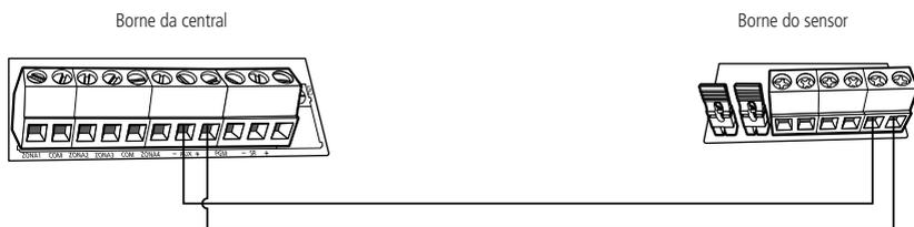
Esta saída é utilizada para alimentar acessórios, como por exemplo, sensores infravermelhos. Recomenda-se a utilização de cabo com bitola  $\leq 26$  AWG (0,41 mm).
