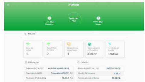
O W4-300F conta ainda com protocolo **IPv6 com autoconfiguração**, ou seja, ele **não necessita de configuração adicional** para que você possa utilizá-lo. As informações de endereçamento são mostradas na **dashboard** da interface web do produto.
