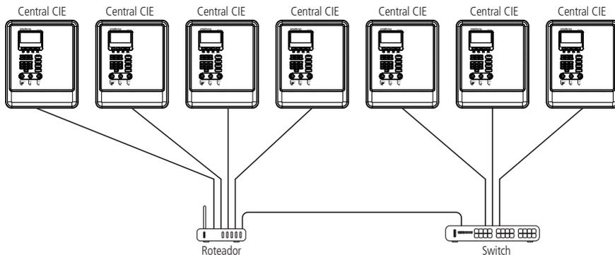
**Atenção:** » A interligação deve ser feita em uma rede isolada, exclusiva para as Centrais de Incêndio, sem conexão com a rede externa (Internet). A conexão em redes Ethernet compartilhadas com outros dispositivos pode comprometer a segurança e integridade do sistema e ocasionar o mau funcionamento do mesmo.
