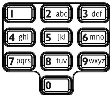
Teclas utilizadas para edição dos campos de configuração da central e digitação das senhas de acesso. Nas demais condições de uso, o teclado é utilizado para entrada da senha, que é numérica.
