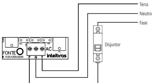
Conexão da rede elétrica
