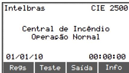
No caso em que a central estiver configurada para interligação entre centrais, o campo *Teste* é alterado para *Rede* (operações de rede) e o endereço de interligação é mostrado ao lado do modelo da central.
