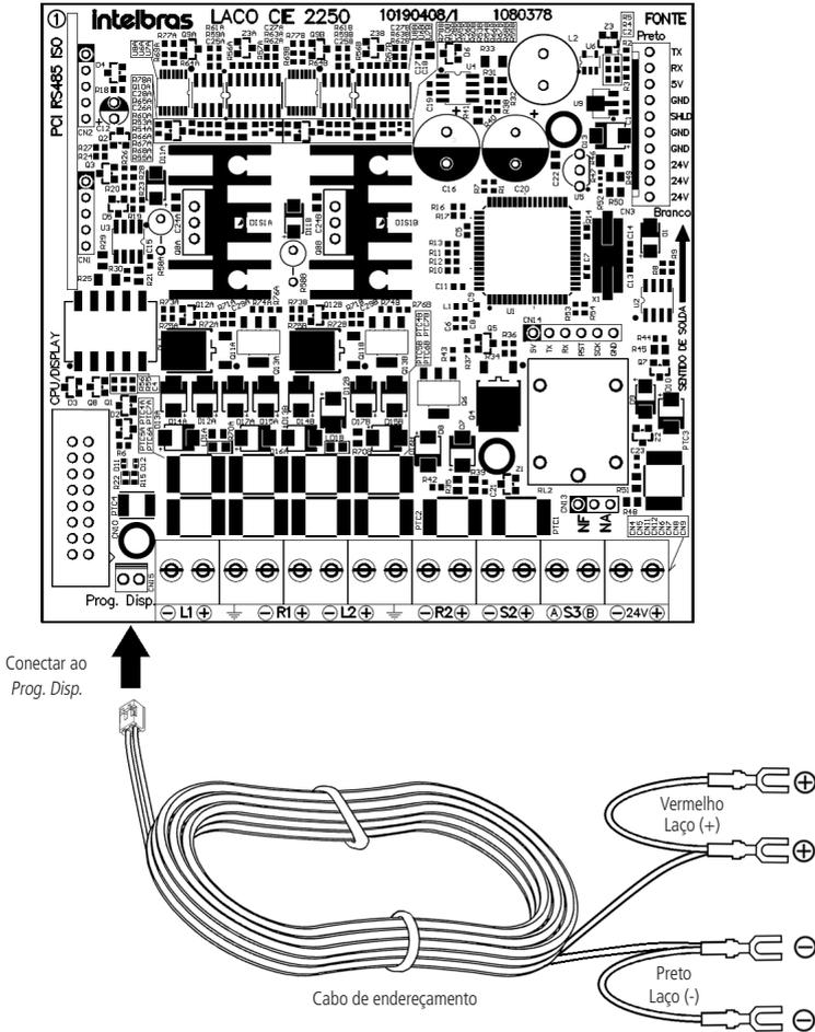
**Atenção:** apenas um dispositivo por vez deve ser conectado ao cabo para programação e/ou leitura do endereço. A conexão de mais de um dispositivo poderá ser indicada pela central como falha e a gravação não será realizada.
