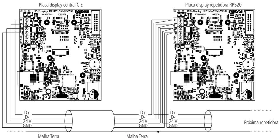
**Atenção:** a malha terra do cabeamento deve ser conectada na placa laço da central em apenas uma das extremidades.
