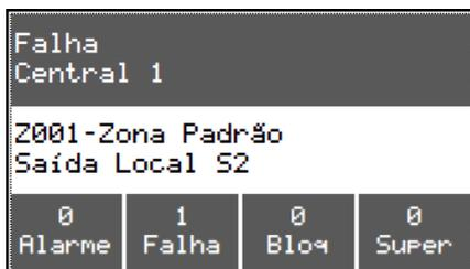
A partir desta tela é possível enviar comandos para a central em falha. Para isso, pressione a tecla contexto indicando falha, selecione a central desejada, pressione a tecla *OK/MENU* para abrir o menu *Detalhes da falha* e acesse a opção 2. *Intelig.: Central*. Abrir o menu *Status central*, pressione a tecla de contexto *Cmds* (Comandos Centrais), escolha o comando e pressione *OK*, a central executará o comando enviado.
