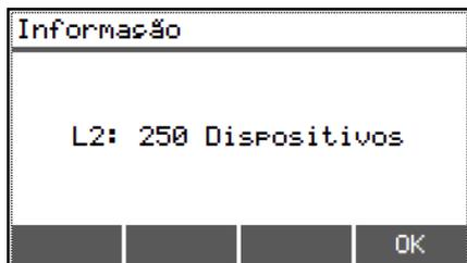
8. Verifique se o número de dispositivos encontrados por laço corresponde à quantidade instalada fisicamente em campo, clique em *OK* e, após, em *OK* para continuar;
