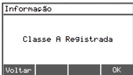
6. Após a seleção da topologia de instalação do(s) laço(s) a central irá iniciar automaticamente o registro (leitura) de todos os dispositivos conectados ao(s) laço(s). Este passo é automático e não necessita de nenhuma interação. Aguarde a conclusão do registro;
