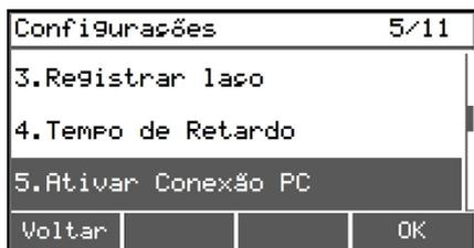
4. Na tela seguinte, escolha o tipo de conexão ao Programador CIE, podendo ser conexão USB e Ethernet ou conexão Wi-Fi.
