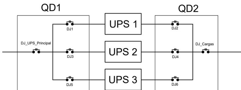
1. Utilize disjuntores na entrada e na saída de cada Nobreak do sistema em paralelo. Utilize quadros de distribuição para separar os disjuntores de entradas (QD1) e os de saída, assim como os disjuntores da distribuição da rede elétrica protegida pelo conjunto de nobreaks (QD2).
