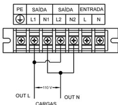
Conecte os terminais L1 & L2 e N1 & N2 para obter uma saída de 110 V nos terminais L1-N1 com 100% da carga do nobreak (115 ou 120 V, dependendo da configuração da tensão de saída do nobreak).
