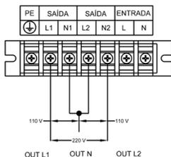
Nessa configuração, os terminais de saída N1 e L2 são conectados, assim se forma 220 V entre L1 & N2 com capacidade de 100% da potência do nobreak. Entre cada fase e neutro é formada uma tensão de 110 V com 50 % da carga do nobreak.
