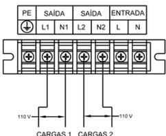
Nessa configuração, são montadas duas saídas de baixa tensão, 110 V, nos terminais L1-N1 e L2-N2 isolados um do outro (115 ou 120, dependendo da configuração da tensão de saída do nobreak). Cada uma dessas fases está separada de 180°. Cada uma das fases pode operar com 50% da capacidade total do nobreak.
