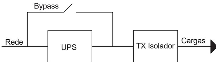
O transformador isolador conta com duas bobinas isoladas no secundário, possibilitando a configuração de tensão de saída de 110 V ou 220 V.
