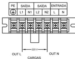
Conecte os terminais N1&L2; isso vai formar uma saída de 220 V entre os terminais L1-N2 (230 ou 240 V dependendo da configuração de tensão de saída do nobreak), com capacidade de 100% da potência do nobreak.
