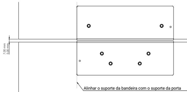
4. Para montagens em portas com abertura externa (opção de montagem possível apenas com a fechadura FE 22150) o suporte SU.A deve ser fixo à porta enquanto o suporte SU.B é fixo à bandeira superior e é necessário a aplicação do suporte auxiliar no suporte SU.A.
