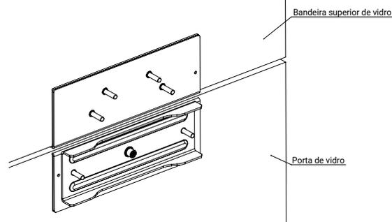
Para o melhor rendimento de tração da fechadura, respeite os limites de distância entre a porta e a bandeira (limite máximo de 7 mm e o limite mínimo de 5 mm).
