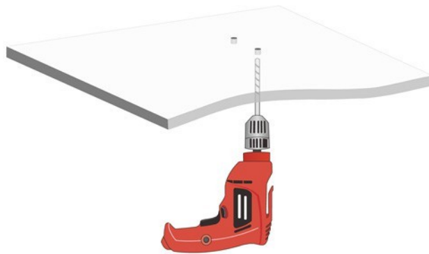
Figura 2-9 Perfuração de orifícios no teto
