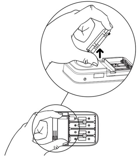
**Atenção:** tanto na retirada como na inserção do módulo ZigBee, tome muito cuidado para não danificar o conector.
