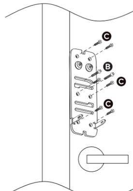
**Importante:** remova os contra parafusos ao instalar em portas com espessura inferior a 35 mm ou ao utilizar calços.
