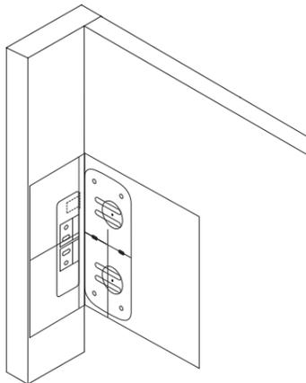
2. Posicione a chapa de fixação sobre o furo, conforme a imagem a seguir:
