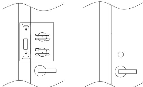
**Importante:** antes de montar o produto, verifique se os acabamentos e/ou vista/guarnição da porta prejudicam a instalação. Pegue a unidade interna e projete a lingueta utilizando a manopla. Coloque-a sobre o local de instalação, juntamente com o batente, conforme a imagem a seguir:
