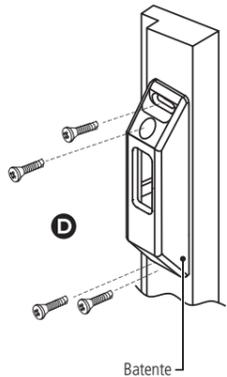
12. Coloque sobre o batente a sua capa para o acabamento final. Dessa forma os furos e as linguetas ficarão ocultos, conforme imagem a seguir:
