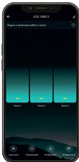
No topo é possível ver o nome adicionado pelo cliente, à direita o ícone para editar o produto e à esquerda o ícone para voltar. No meio da tela encontram-se teclas que ligam e desligam os botões do interruptor. Na parte inferior há encontra-se um ícone de relógio, para acessar o conjunto de funções relacionadas a temporização do aparelho.
