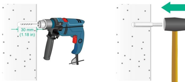
Figura 2-4 Martelando um parafuso de expansão na parede
