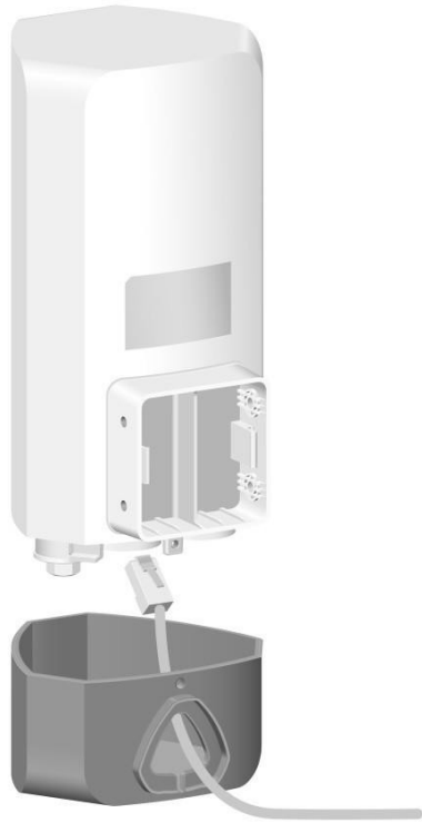
Figura 2-7 Conexão de um cabo ao equipamento
