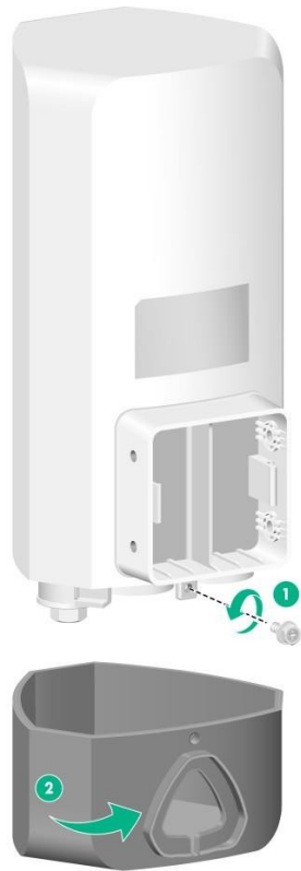
Figura 2-6 Remoção do parafuso de fixação (aterramento) e da base
