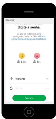
**Obs.:** para roteadores Dual band (2,4 GHz e 5 GHz) caso seu smartphone ou tablet estejam conectados na rede 5 GHz, será necessário utilizar o método alternativo de configuração.
