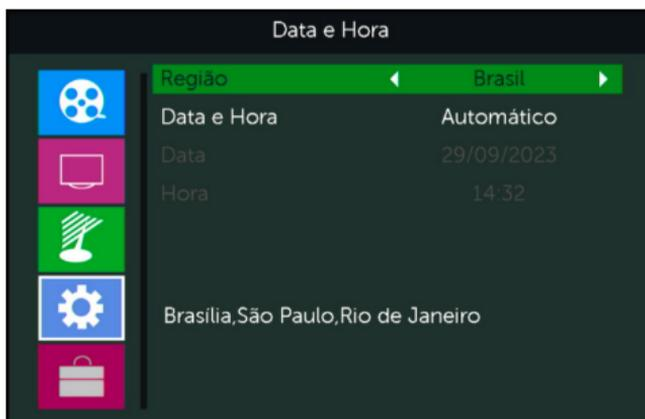
**Atenção:** se o conversor estiver definido com a data e hora manual e este for desconectado da fonte de alimentação ou se faltar energia, estas informações retornarão ao padrão de fábrica.
