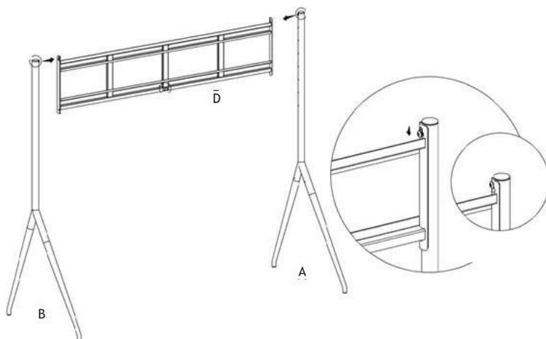
Parafuse a parte inferior do painel D utilizando mais dois parafusos F e aperte com a chave I.
