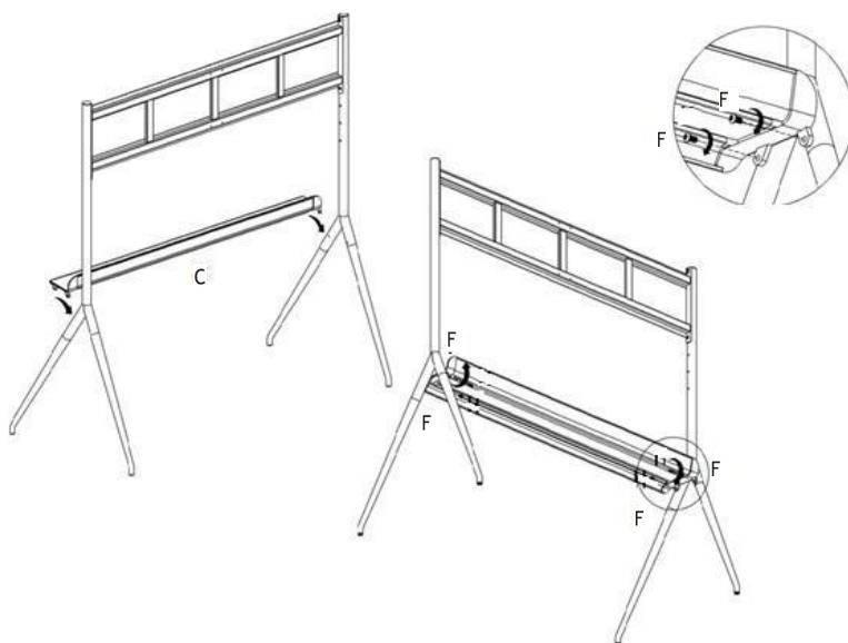
Após colocar a prateleira, aperte os 8 parafusos F de modo que a estrutura fique bem firme.
