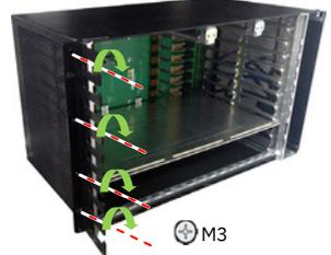
**4** Instale as orelhas de montagem do adaptador.
