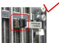
Coloque uma tampa antipoeira em um módulo óptico não utilizado.
