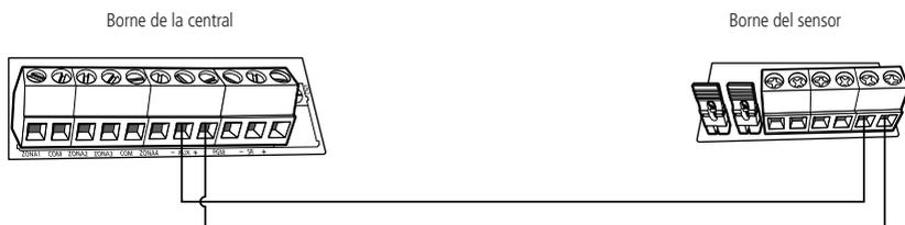
Esta salida se utiliza para alimentar accesorios como por ejemplo, los sensores de infrarrojos. Se recomienda utilizar cable con calibre  $\leq 26$  AWG (0,41 mm).
