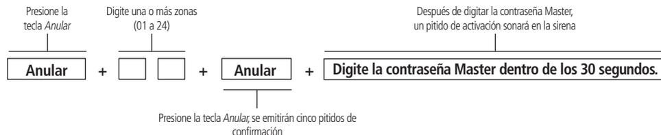
Permite la anulación temporal de una o varias zonas. Este procedimiento debe ejecutarse como máximo 30 segundos antes de la activación del sistema. Después de ser desactivadas, las zonas que estaban anuladas volverán a su funcionamiento normal.
