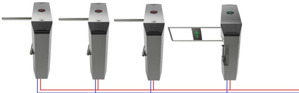
Es necesario pasar los cables por las aberturas de la parte inferior de los torniquetes, como se muestra en la imagen superior.
