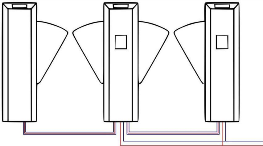
\* É necessário realizar a ligação da placa máster com a placa slave, o que pode ser feito utilizando dois cabos CAT5 e um em paralelo para alimentação 24 V do motor.
