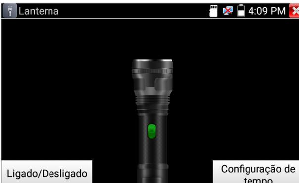
Pressione o botão **Ligado/Desligado** para ligar ou desligar a lanterna do TESTER 3000.
