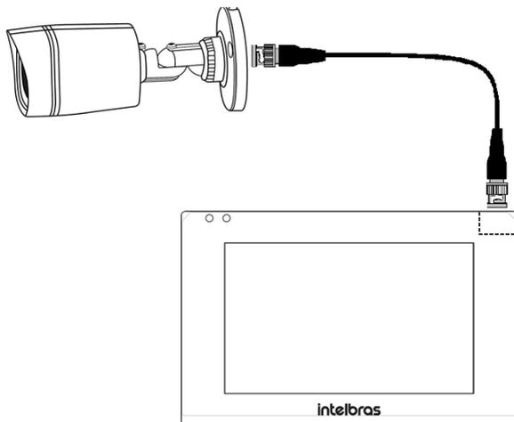
A alimentação da câmera analógica poderá ser feita através de fonte externa ou da saída 12 Vdc do TESTER 3000 MT.
