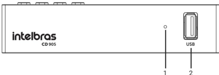
1. **LED:** na cor vermelha, indica que o conversor está desligado. Na cor verde, indica que o conversor está ligado.
