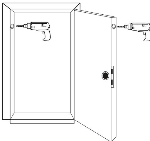
2. Coloque el imán en la parte móvil y el reed switch en la parte fija de la estructura.
