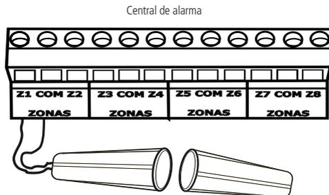
5. Después de la instalación, verifique que al alejar el imán del interruptor de lengüeta, el panel de control se apague indicando que hubo una violación. Si es necesario, ajuste la posición del sensor.
