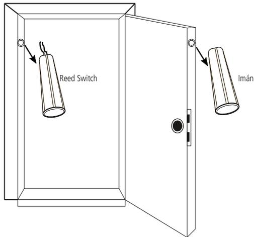
3. Verifique que la distancia desde el GAP<sup>1</sup> esté dentro de lo especificado, para evitar disparos no deseados en caso de cualquier vibración en la estructura donde está instalado el sensor.
