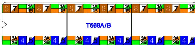
2. Realizar a crimpagem dos fios utilizando o alicate de inserção Punch Down.
