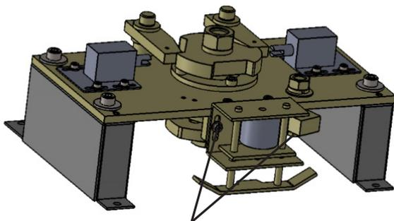
Com uma chave Allen de 4 mm, solte os parafusos
