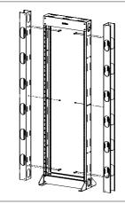
Remova a tampa lateral do OCV, posicione a moldura no local indicado de seu Rack RT e a fixe utilizando os parafusos (05 parafusos).
