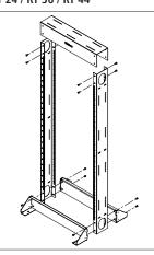
Posicionar as peças e após fixá-las com os parafusos nos locais indicados (16 parafusos).
