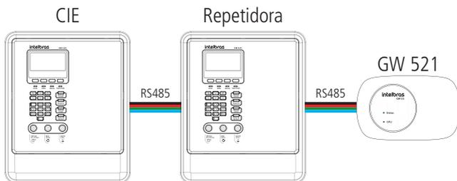
A comunicação entre a CIE e o GW 521 deve ser habilitada na Central CIE através do Programador CIE ou manualmente no *Menu > Configurações > Endereços Repetidoras > GW 521 (Ativo)*.
