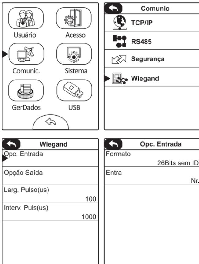
1. Selecione o formato, de acordo com a quantidade de bits do leitor utilizado e do modelo. Para o SS 420, usar o formato 26 bits sem ID e configurar o leitor auxiliar para 26 bits. No SS 420 MF usar o formato 34 bits sem ID e configurar o leitor auxiliar para 34 bits;
