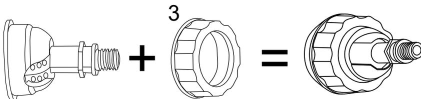
» Insira a porca no conector (peça 5 e 6); Instalação com uso do articulador:
