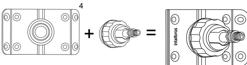
» Remova a placa e faça um furo no local indicado na base utilizando uma furadeira ou a ferramenta que julgar adequada, verifique se o furo feito permite a passagem do eixo do suporte. Em seguida, insira a porca no alojamento localizado na parte interna da base;
