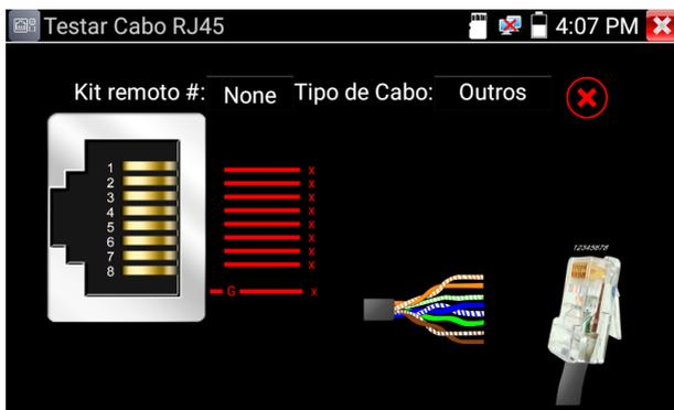
Conecte o cabo RJ45 entre a porta UTP/SCAN do TESTER 3000 MT e o dispositivo<sup>1</sup> No.255 que acompanha o produto. Após a conexão abra o aplicativo e o teste iniciará automaticamente.
