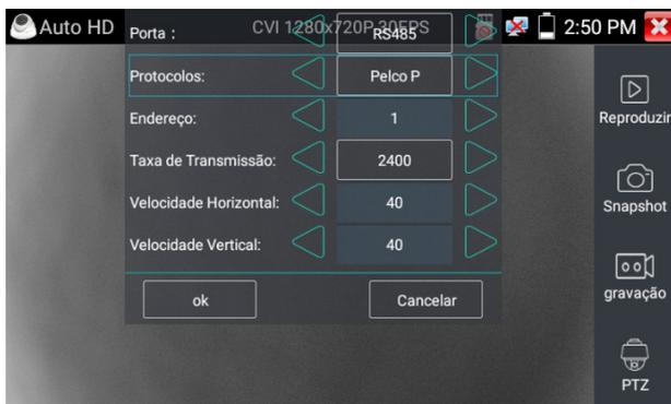
Se a câmera utilizada não é HDCVI, o controle poderá ser feito através da conexão RS485 com os protocolos PELCO P ou PELCO D. Certifique-se que a taxa de transmissão é a adequada.
