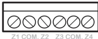
A ligação dos sensores com fio nos bornes das zonas da central de alarme deve ser feita com cabo 4×26 AWG ou superior, com comprimento máximo de 100 m e resistências total de 40 Ω.
