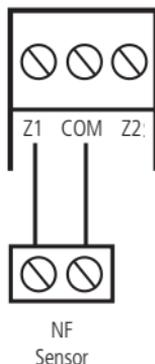
**Obs.:** se estiver utilizando o teclado XAT 4000 LCD, utilize o fio azul para a zona 1 teclado, o fio branco para a zona 2 e o comum do sensor (COM) deve ser conectado ao fio preto do teclado.
