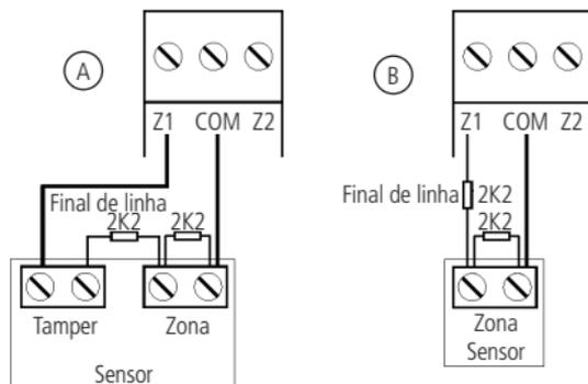
» **Figura A:** ligação para sensores que possuem tamper.
