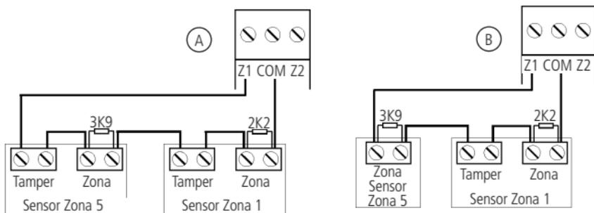
» **Figura A:** ligação para sensores que possuem tamper.
