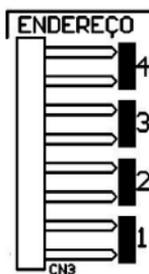
Todos os teclados saem de fábrica com o jumper na posição 1. Se for utilizar mais de um teclado (até 4 teclados), o segundo teclado deve ficar com o jumper na posição 2, conforme exibido a seguir e assim por diante.
