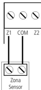
**Obs.:** se estiver utilizando o teclado XAT 2000 LCD ou XAT 3000 LED, utilize o fio azul para a zona 1 do teclado, o fio branco para a zona 2 e o comum do sensor (COM) deve ser conectado ao fio preto.
