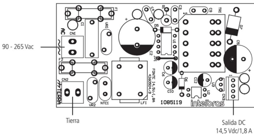
(Se recomienda utilizar un cable con calibre  $\geq 1$  mm)
