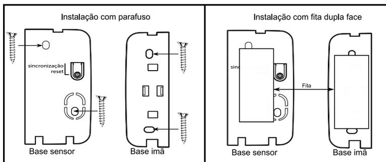
**Importante:** verifique se a distância do GAP (distância entre o sensor e o ímã) está dentro do especificado, para evitar disparo indesejado caso ocorra alguma vibração na estrutura em que o sensor está instalado.
