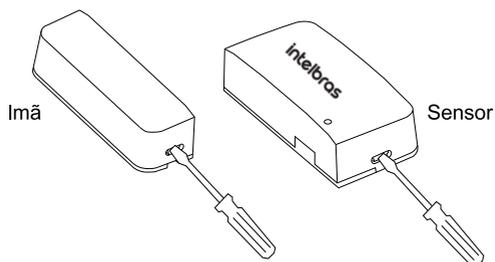
Remova a placa, em seguida ensira a bateria (modelo CR2450), respeitando a polaridade.
