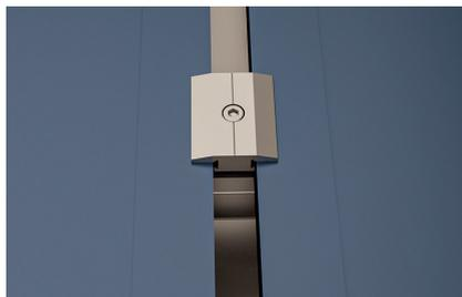
**Obs.:** o grampo intermediário e o grampo final atendem os módulos com altura de 30 a 40 mm e são dotados de engate rápido que permite o encaixe utilizando-se apenas uma mão, seguido de aperto.
