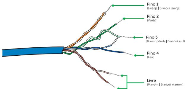
**Atenção:** quando a instalação for acima de 50 metros recomenda-se interligar o par de fios Marrom | Branco/marrom na conexão 3 do monitor e módulo externo.
