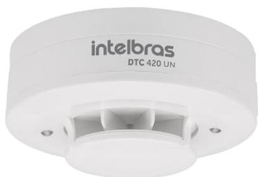
O detector de temperatura convencional tem como principal característica o disparo por termovelocimétrico (variação brusca de temperatura) ou temperatura fixa (60 °C ±5 °C). Ao disparar, enviará um comunicado à central de alarme incêndio, informando sobre o indício de incêndio. Conta com baixo consumo de corrente elétrica e design tecnológico
