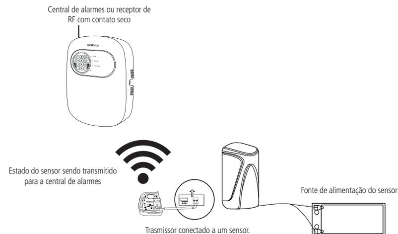
**Obs.:** o transmissor possui bateria interna para o seu funcionamento.
